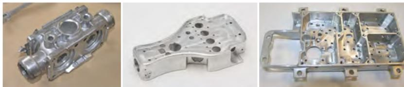
Д16 — это конструкционный термоупроченный и естественносоставленный сплав в заготовке, который применяется в различных областях народного хозяйства. Его применяют и для изготовления силовых элементов конструкций в авиатехнике: деталей обшивки, каркаса, шпангоутов, нервюр, тяги управления, лонжерон и т.д.
