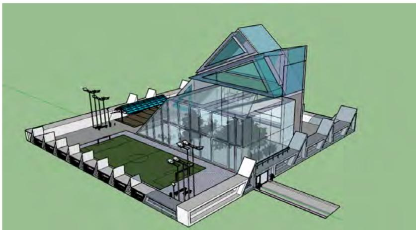
Одно из нестандартных архитектурных решений проекта 3D модели, обилие стекла и панелей которые пропускают внешний свет, в каркасе здания. Это дает сооружению быть более «воздушным». Так же, не мало важно помнить, что художники пишут картины при дневном свете и большие окна решают проблему освещения в художественных мастерских.
