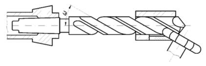
Фрезерование винтовых стружечных канавок
