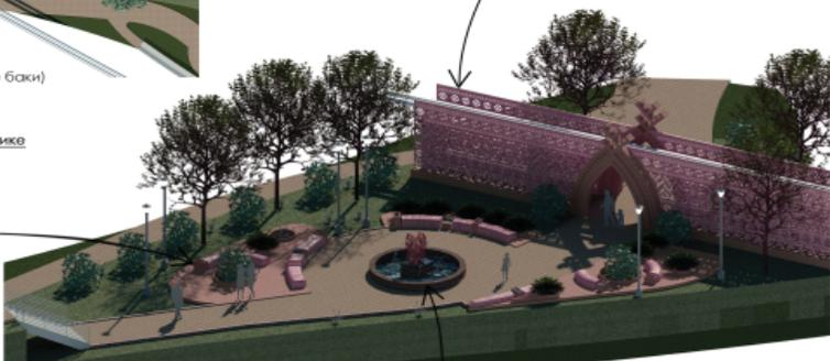
Ажурное ограждение от труб теплотрассы, в проеме которого возможно размещение общественных урновых. В ночное время суток между ограждениями включается сиреневая подсветка. Засчет резких узоров на земле образуется интересная игра света и тени. Длина МАФ варьируется в зависимости от длины теплотрассы на территории.
